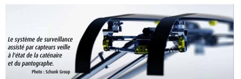
Le système de surveillance assisté par capteurs veille à l'état de la caténaire et du pantographe.
