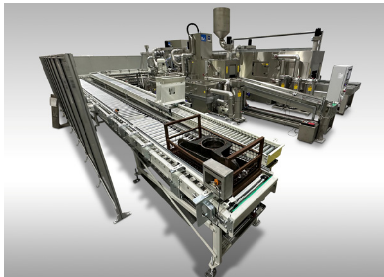
Une combinaison de deux installations de nettoyage en continu : un système unique pour le lavage des boîtiers de roulements et des roulements à rouleaux cylindriques et coniques
